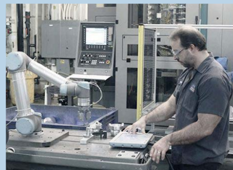
Figuur 2 2 Voorbeelden van geavanceerde industriële machines (GIMs) die meerdere taken kunnen uitvoeren, bij de mens op de werkvloer zijn, en over machine learning technologie beschikken.
