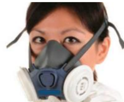
Half gelaatmasker met P3 filter Kans op lekkage langs masker. Fittesten noodzakelijk.
